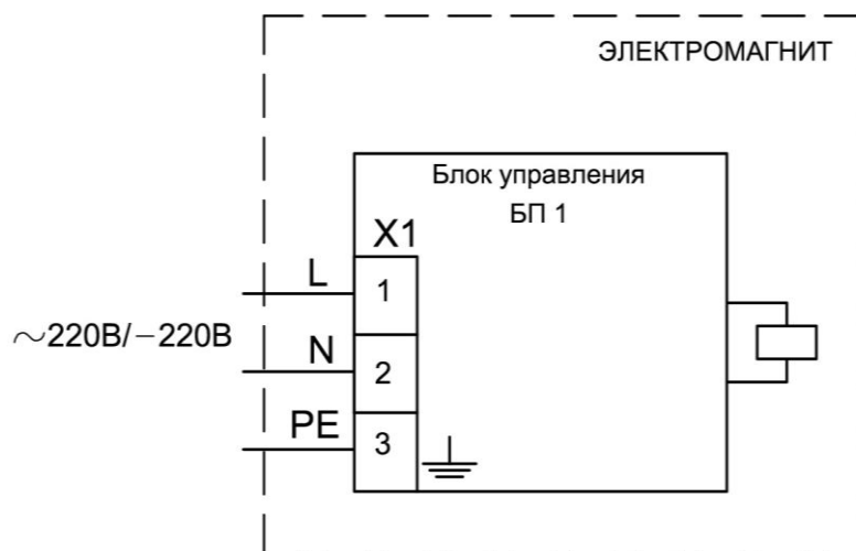
Рисунок 8. Схема подключения датчика бесконтактного индуктивного общепромышленного (исполнение «Д»)
