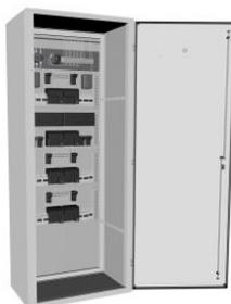
НКУ серии РТЗО-88М, РТЗО-88В предназначены для питания и управления электроприводами мощностью до 10 кВт и 14-28 кВт запорной регулирующей арматуры для промышленности и коммунального хозяйства, а также электродвигателями мощностью до 11 кВт механизмов собственных нужд электрических станций (ТЭС, ГЭС).
